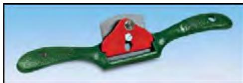
Alat ini berfungsi untuk mengaluskan bentuk-bentuk yang lengkung atau cekung
