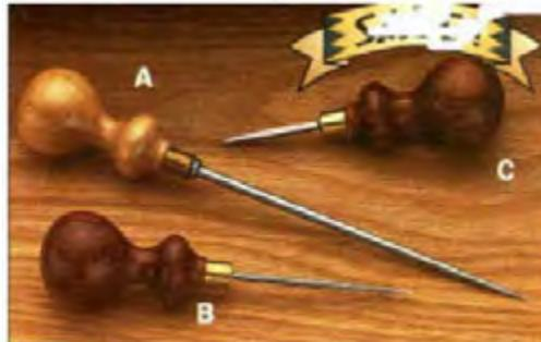
Penggores adalah alat yang terbuat dari logam berbentuk silindris lurus dan diruncingkan dibagian ujung depan. Fungsi penggores adalah untuk membuat
