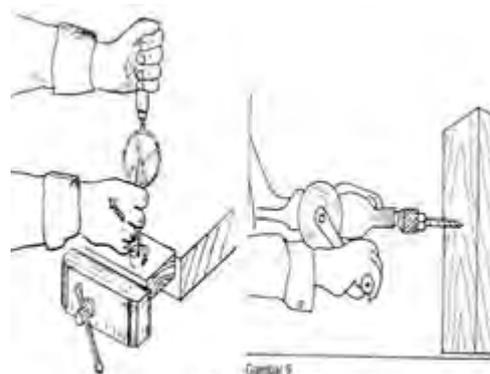
untuk membuat lubang bulat silinder pada benda pekerjaan, pada saat menggunakan bor tangan bisa cara mengebor posisi vertikal maupun posisi
