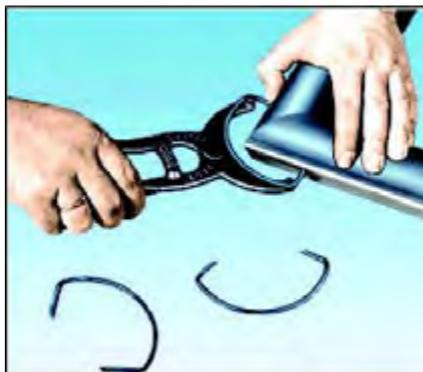
Alat ini dapat digunakan khusus untuk mengklem sudut bingkai atau pada konstruksi yang
