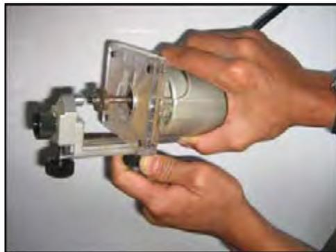
Alat ini sangat baik untuk mengerjakan bagian tepi kayu keras/*plywood*, mebel, pintu. Stel ketiga sekrup sesuai dengan keinginan. Klem sekrup
