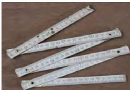
Meteran lipat yang diperdagangkan dibuat dari bahan kayu, plastik dan baja. Meteran lipat mempunyai panjang dari 1 - 2 meter. Meteran lipat
