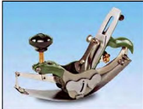
Alat ini berfungsi untuk mengetam bentuk lengkung baik cekung maupun cembung.
