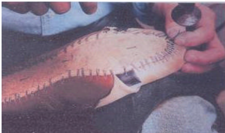
Gambar. Mengopen lapis depan
