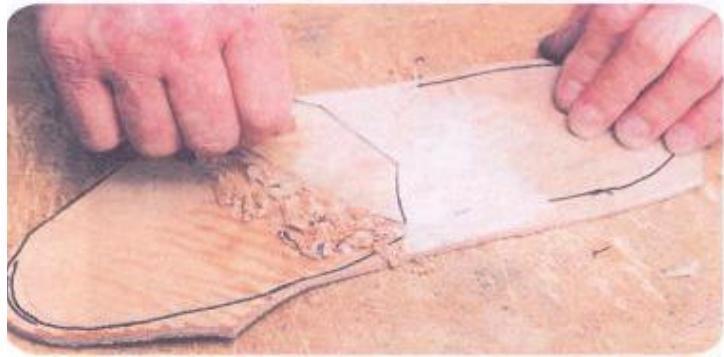
Gambar Meratakan bahan sol dalam dengan pecahan kaca
