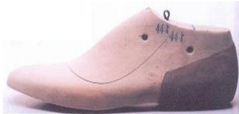
Gambar. Cetakan penguat belakang sepatu Setelah penguat sepatu selesai dicetak maka dilepas untuk proses selanjutnya.
