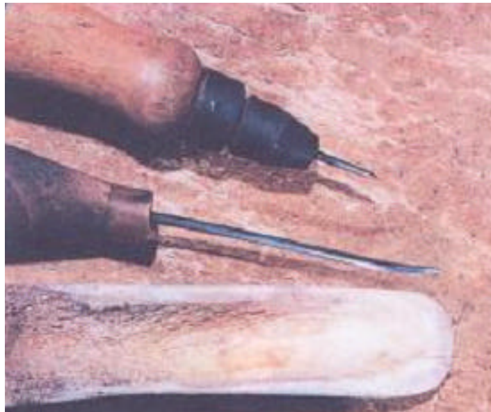
Gambar. Alat pelubang jahit pita (tengah), alat pelubang paku pasak (atas), pisau tulang untuk menghaluskan/mengkilapkan pita sepatu.
