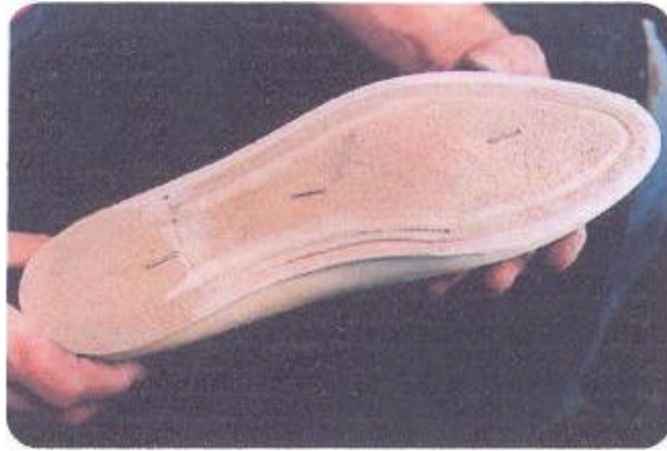
Gambar. Memasang sol dalam
