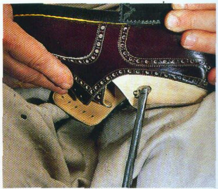
Gb, Penempatan acuan untuk mencari Ukuran
