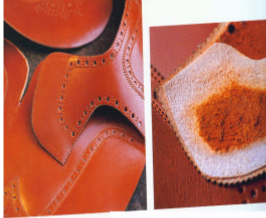
Gambar 203 Potongan Kulit yang Sudah Di Seset
