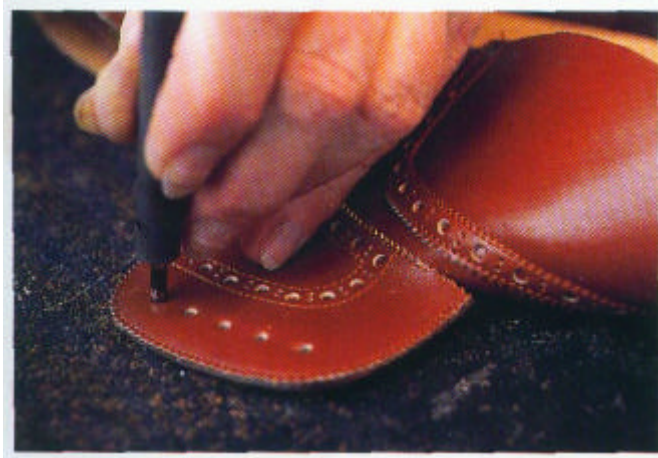
Gb, Pembuatan lubang hiasan
