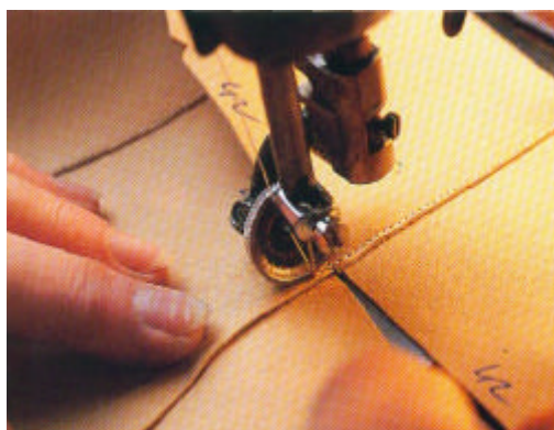
Gb. Menjahit Lapisan Bagian Dalam Sepatu
