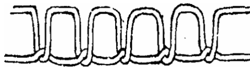
Gambar 43, penyetelan benang diputar se arah jarum jam
