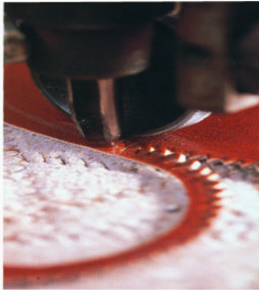
Gb., Memotong kulit dengan alat potong hias
