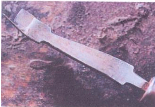
Gambar. Alat penyeset sol dalam
