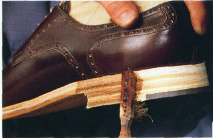
Gb, Pemberian warna pada bagian bawah sepatu
