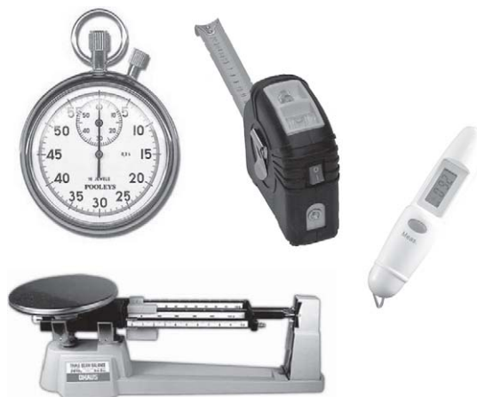
Gambar 1.1 Beberapa jenis alat ukur untuk besaran besaran panjang, suhu, waktu dan massa.
