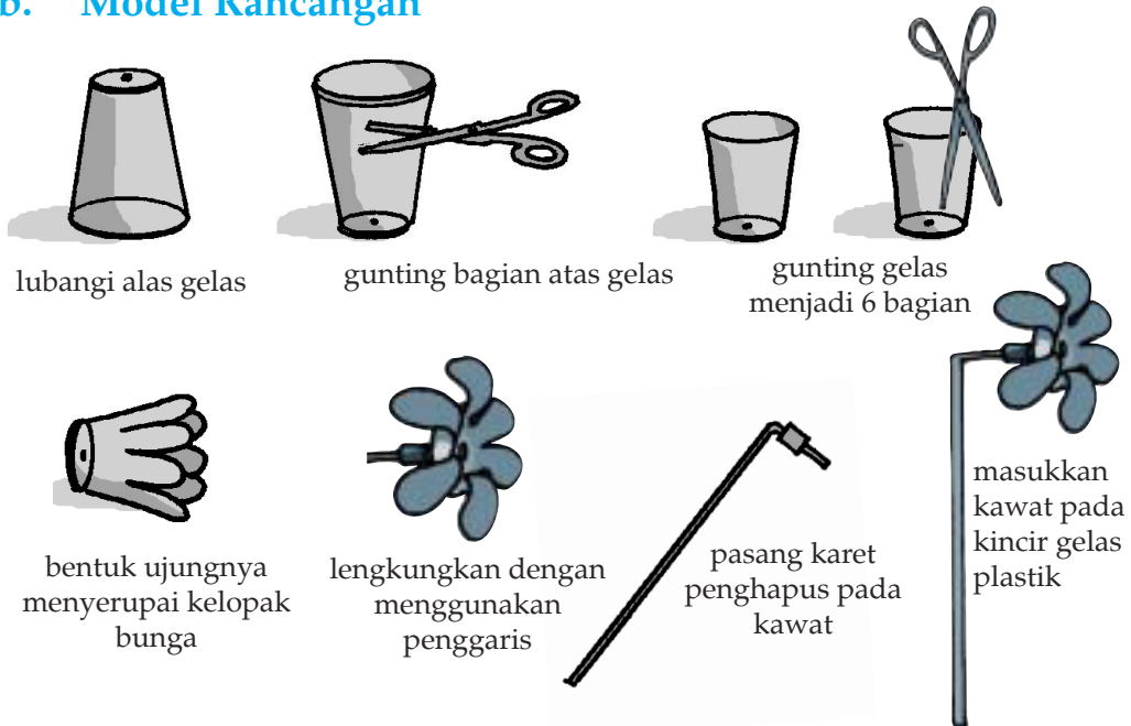
Gambar 6.22 Model pembuatan kincir angin dari gelas plastik
