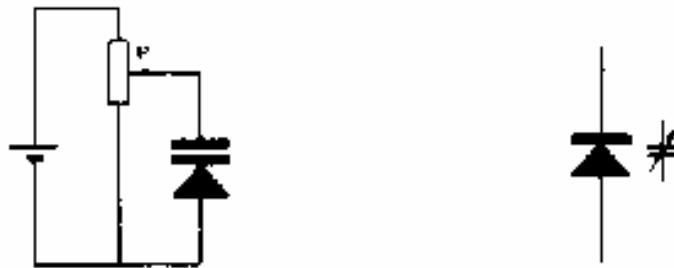
Gambar 2.15. Bagan dan simbol Dioda Varactor
