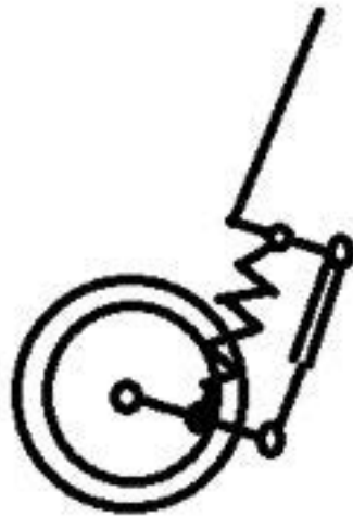
Gambar 2. Konstruksi suspensi leading link
