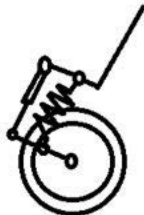
Gambar 3. Konstruksi suspensi trailing link
