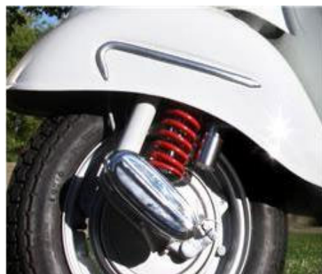
Gambar 3. Konstruksi suspensi trailing link
