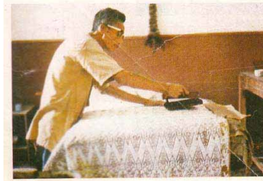
Gambar 12 – 14 Melekatkan Lilin dengan Canting Cap
