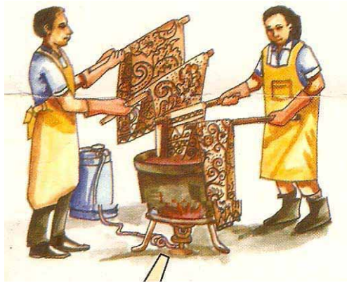
Gambar 12 – 11 Menghilangkan Lilin Batik ( Melorod )
