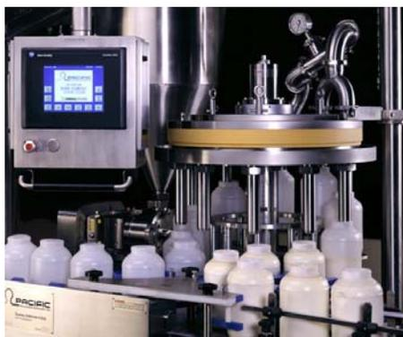
Gambar 6.7 Pengisian produk cair dengan teknik *measured dosing*.
