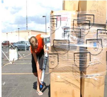
Gambar 6.11 Pengemasan kardus dengan *shrink-wrapping*.
