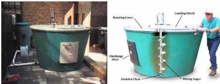
Gambar 7.28 *Mechanical Compost Bins* dan Pengoperasiannya (Isro'i, tanpa tahun)
