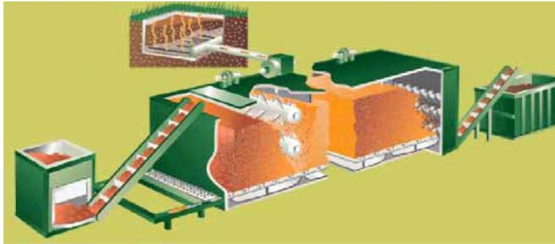
Gambar 7.26 Pengomposan dengan Teknik *Box/Tunnel Composting System* (Isro'i, tanpa tahun)
