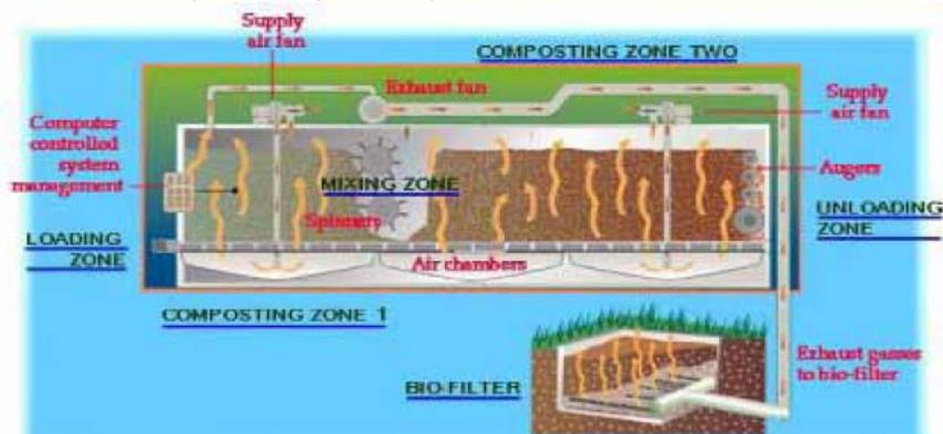
Gambar 7.27 Skema Pengomposan di dalam *Box/Tunnel Composting System* (Isro'i, tanpa tahun)
