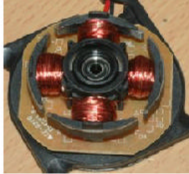
Gambar 5.45 Kutub pada stator motor DC brushless 2 fasa
