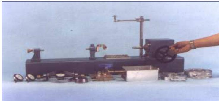
Gambar 5.5. Alat uji geser langsung (*direct shear test*)
