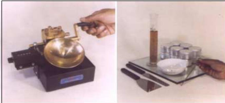
**Gambar 5.3. Alat uji Batas Cair dan batas plastis: Cawan Cassagrande**
