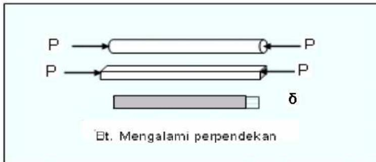
**Gambar 3.48. Tegangan normal tekan pada batang prismatik**
