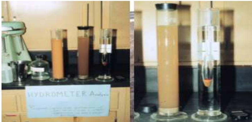
**Gambar 5.2. Set alat uji Hidrometer**
