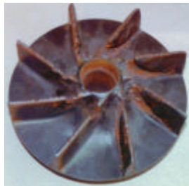
Gambar 6.16 Abrasi pada impeler
