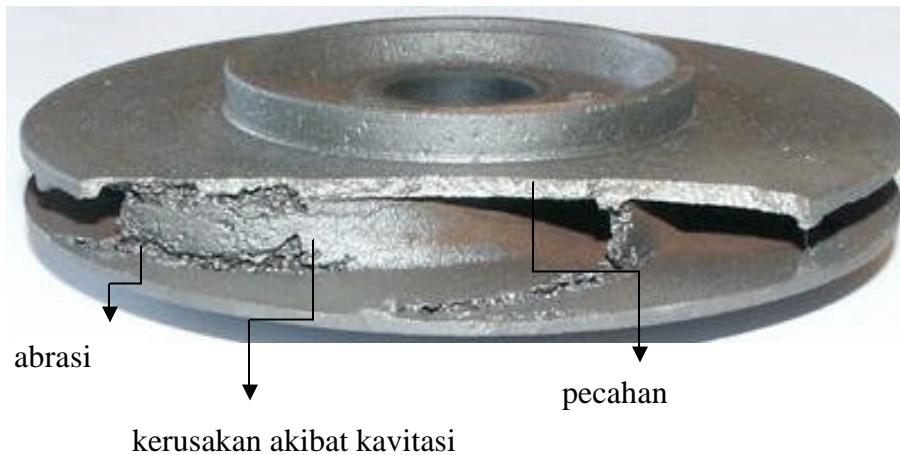
Gambar 6.17 Kerusakan impeler karena kavitas
