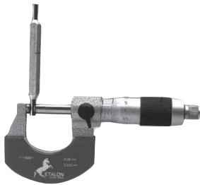
Gambar 1.13 Mikrometer memiliki skala tetap dan skala nonius.
