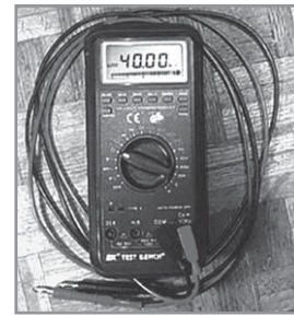
Gambar 7.20 Multimeter untuk mengukur beda potensial, kuat arus listrik, dan hambatan.
