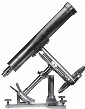
Gambar 5.14 Teleskop pembias abad ke-19.
